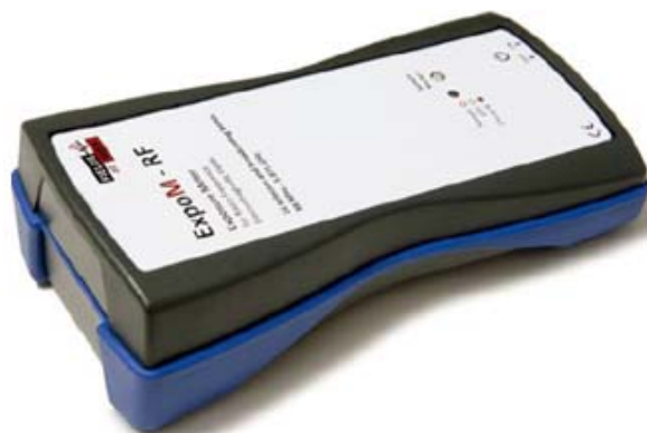
Slika 5.4 - NARDA ExpoM RF ekspozimetar
