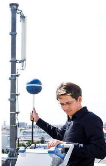
Slika 5.11 - Rohde & Schwarz TS-EMF senzor u operativnom radu
