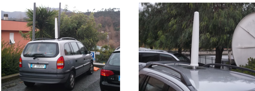
Slika 5.3 – NARDA širokopojasni senzor na krovu vozila u funkciji mobilnog senzora
